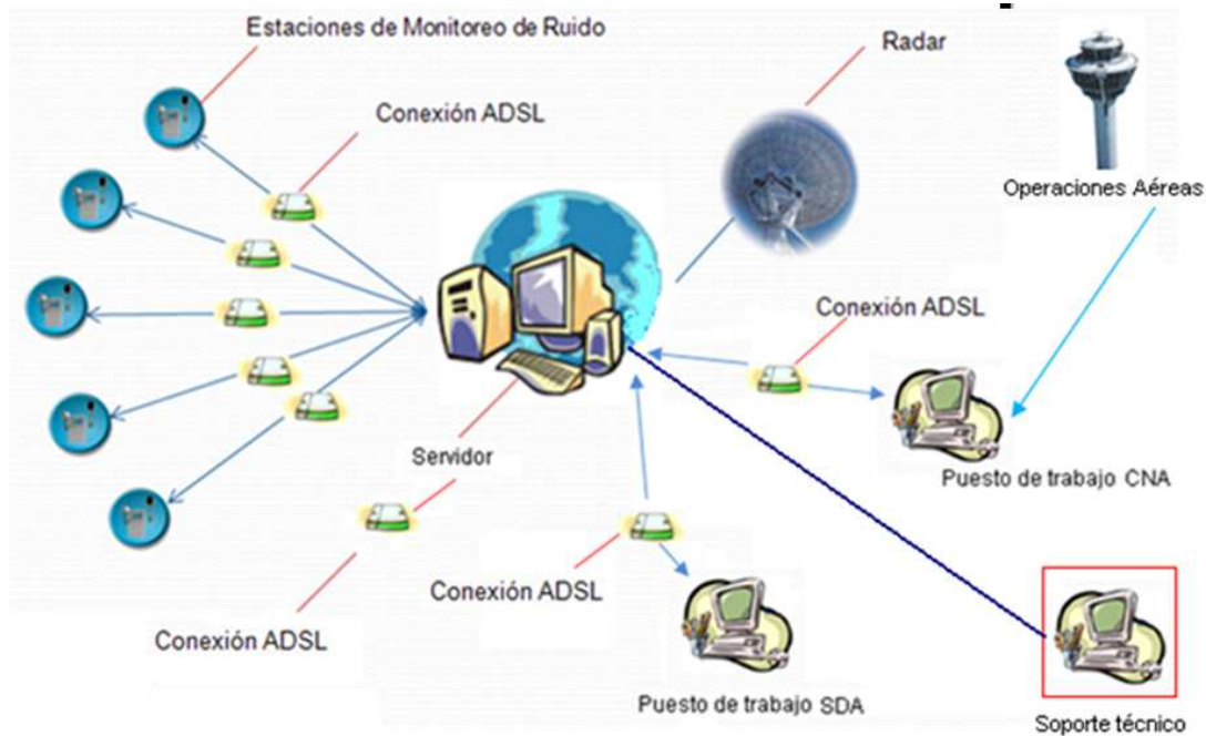
ILUSTRACIÓN 1. ESQUEMA DE LA RED DE MONITOREO DE RUIDO PARA EL AEROPUERTO INTERNACIONAL EL DORADO.
